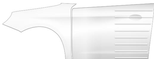
Appliquer Cromax® EZ+ Raccordeur (non activé) sur la zone de raccord restante, ne pas laisser s'évaporer.
